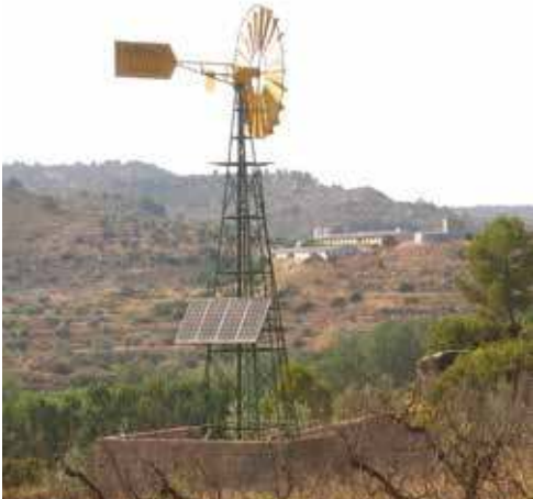
Molino de viento para extracción de agua.
